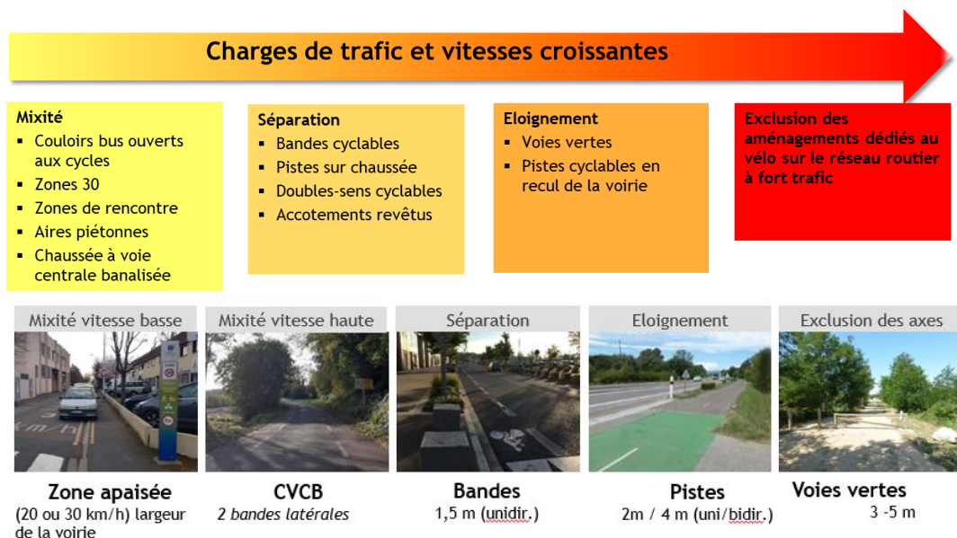
Figure 1 : Principes d'aménagements en fonction de la charge de trafic et des vitesses croissantes (source : Explain)
